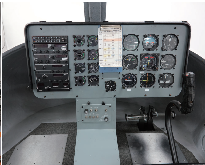
●フラスカ式342型の計器板。本FTDはベル206型単発タービン・ヘリコプターを模擬するもので、計器板はアナログ計器で構成されている。
