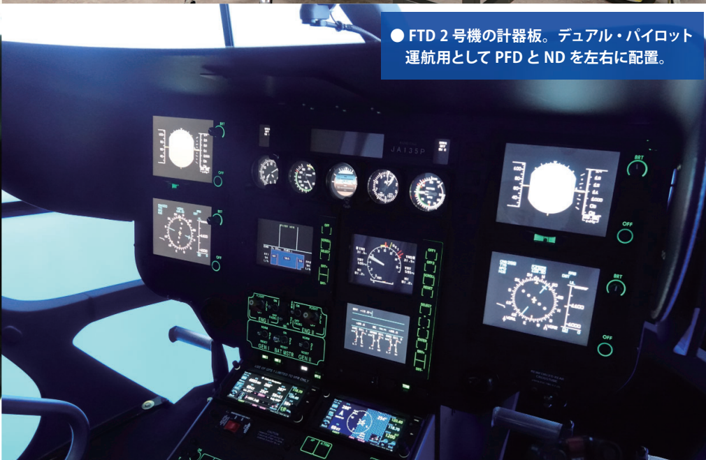
● EC135P2（プラット・アンド・ホイットニー・カナダ製 PW206B2 型エンジン搭載）型用の FTD 2 号機。外観上、FTD 1号機と似ているが、液晶 5 画面を採用している。
